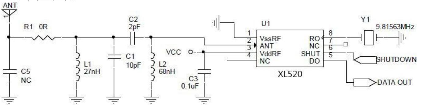
图1 315MHz 1 kbps典型电路
