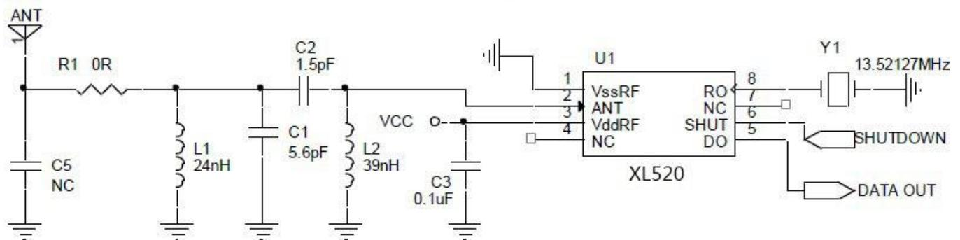
图2 433.92MHz 1 kbps典型电路
