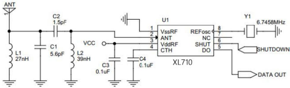
图2 433.92MHz 1.5kbps典型电路
